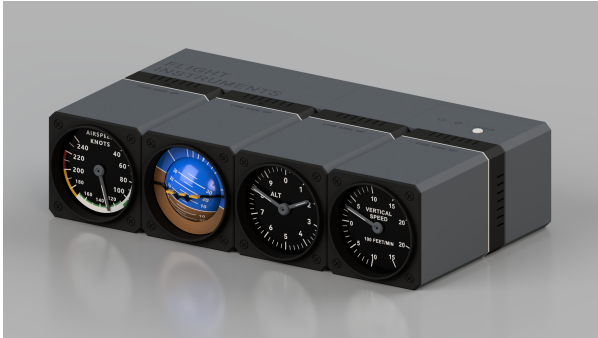
Fig. 6: Sistema completo con los cuatro módulos indicadores acoplados al módulo master.
