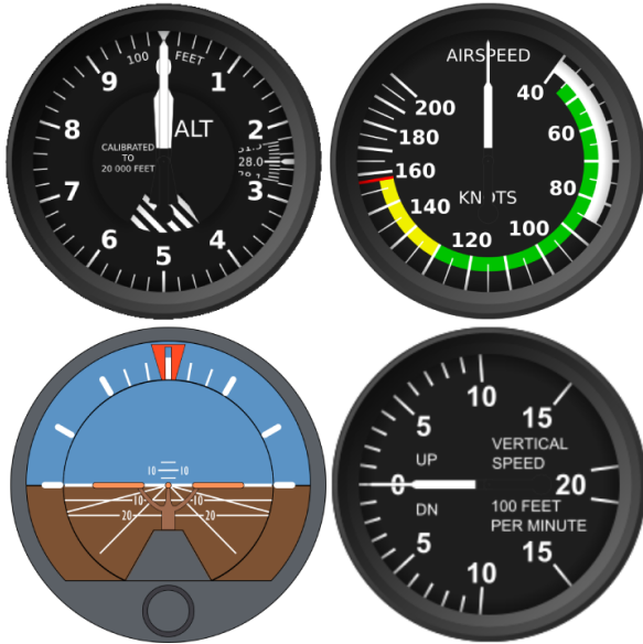
Fig. 1: Conjunto de instrumentos del panel: altímetro (arriba izquierda), indicador de velocidad aérea (arriba derecha), indicador de actitud (abajo izquierda) e indicador de velocidad vertical (abajo derecha).
