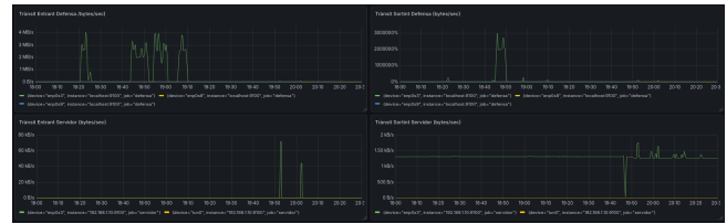
Fig. 5: Monitoratge del trànsit de xarxa durant l'execució d'atacs
