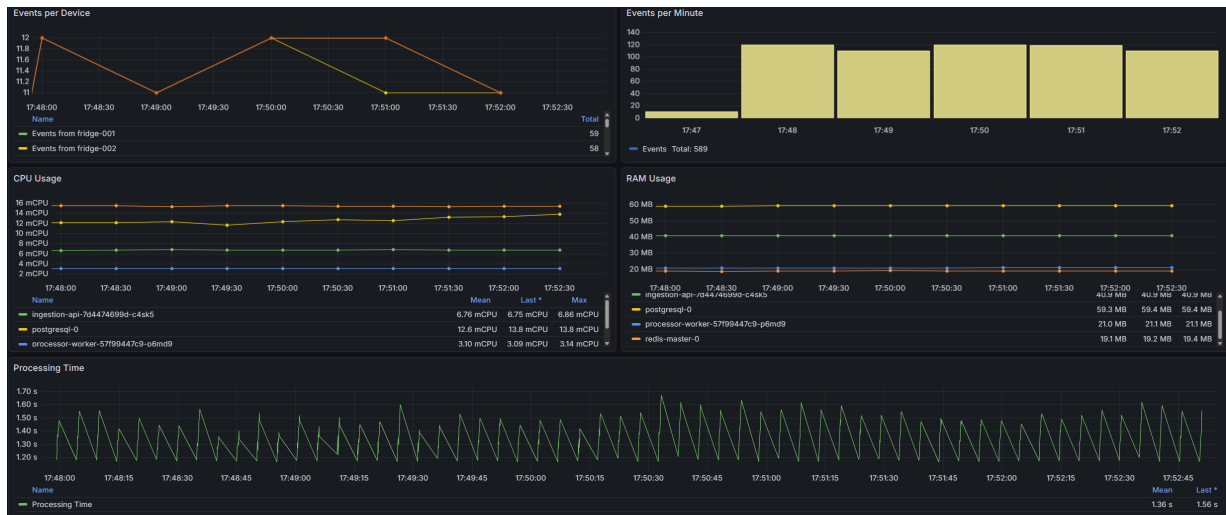
Fig. 13: Prova de càrrega amb 10 neveres simulades.
