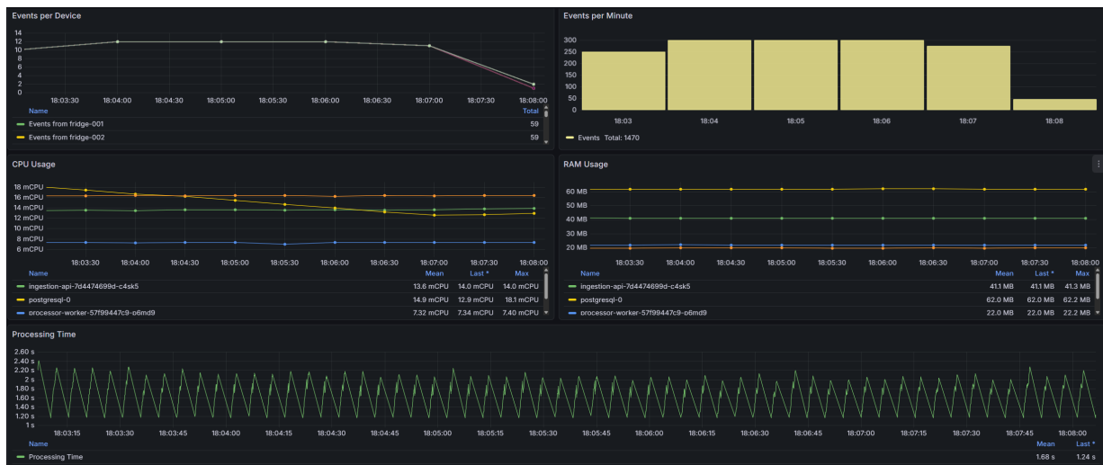
Fig. 14: Prova de càrrega amb 25 neveres simulades.
