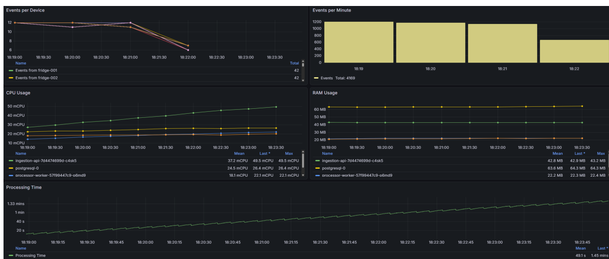
Fig. 16: Prova de càrrega amb 100 neveres simulades.
