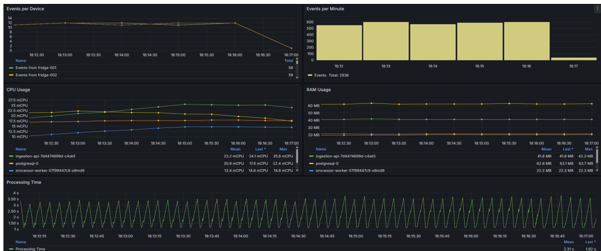
Fig. 15: Prova de càrrega amb 50 neveres simulades.
