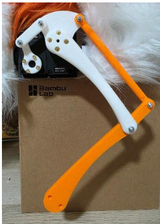
Fig. 3. Disseny de les potes de NOVA amb mecanisme de paral·lelogram imprès en 3D.
