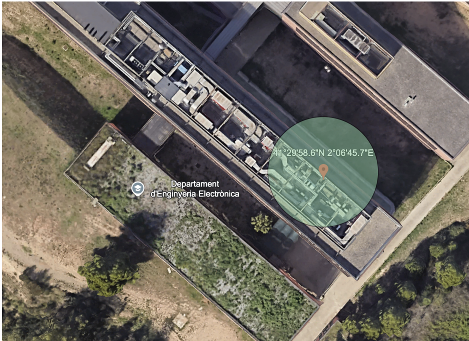
Figura 5.6: Solució PVT semiautenticada calculada sobre la banda auxiliar, situada sobre el terrat del Departament d'Enginyeria Electrònica (UAB). El cercle verd marca el radi d'incertesa de la posició estimada.
