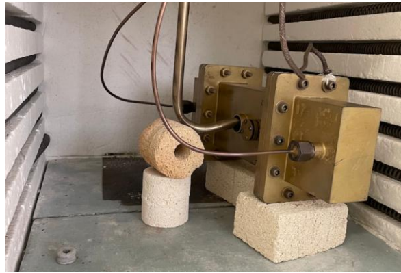
Figura 2-3: Cavity resonante ubicada en el interior del horno para ensayos a alta temperatura. Fig 1 de [18].
