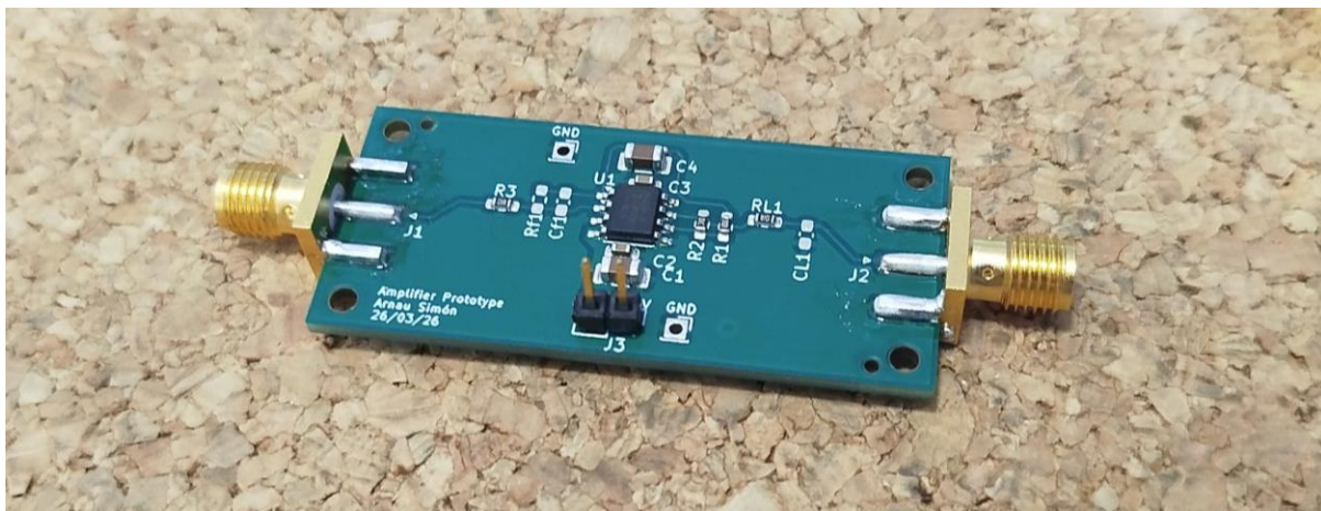
Figura 38. Fotografia del prototip PCB final completament muntat, amb tots els components soldats i els connectors SMA instal·lats.
