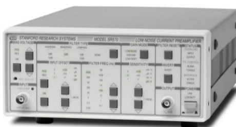
Figura 6. Stanford Research Systems SR570. Preamplificador de corrent de baix soroll.
