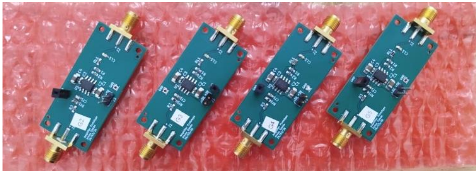
Figura 41. Quatre unitats del prototip PCB electròmetre.
