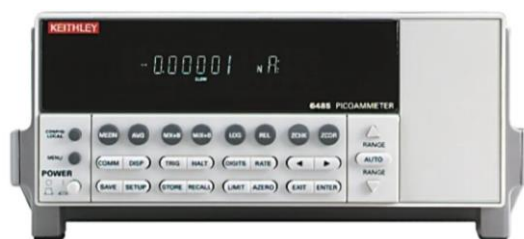
Figura 5. Instrument de banc Keithley 6485 Picoamperímetre.
