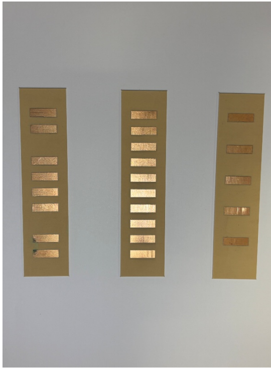
Figura 4.4: Tags fabricados para la validación del sistema.
