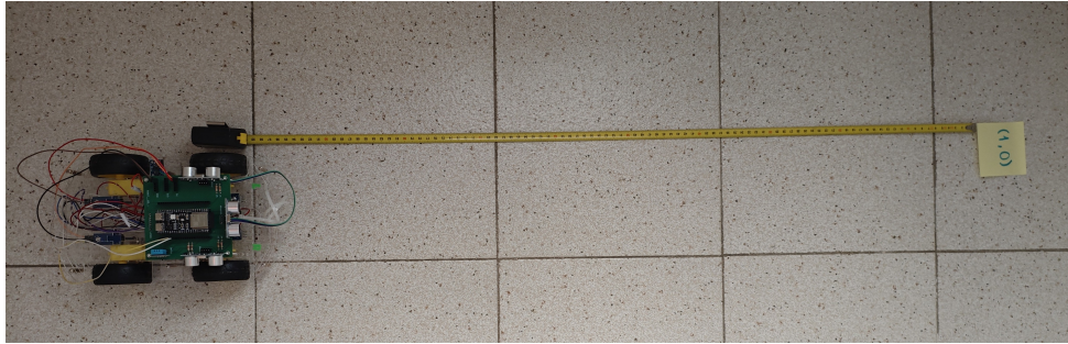
Figura 7.3: Robot al punt de partida, amb el metre marcant la distància d'un metre a recórrer.
