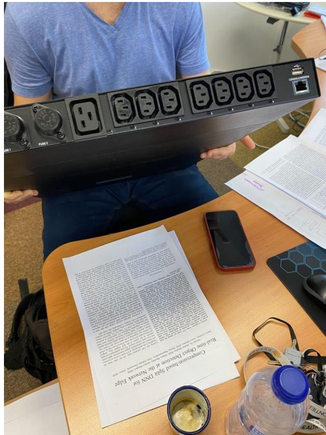
Fig. 1. Aparell per mesurar el consum energètic del servidor. Fotografia pròpia.
