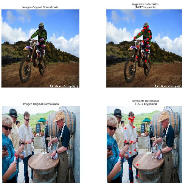
Fig. 12. Puntos de interés obtenidos a partir de los heatmaps individuales de cada clase, displayKeypoints() , de las dos primeras imágenes de dos batches consecutivos. Característica extraída una vez realizada la distribución Gaussiana.
