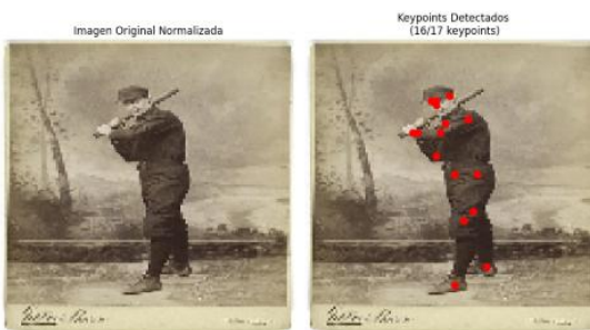
Fig. 9. Puntos de interés obtenidos a partir de los heatmaps individuales de cada clase, displayKeypoints() . Característica extraída una vez realizada la distribución Gaussiana.
