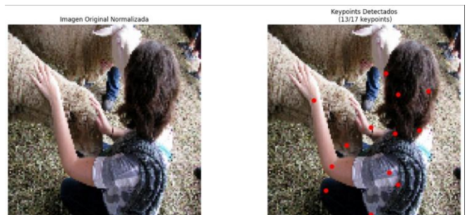
Fig. 14. Puntos de interés obtenidos a partir de los heatmaps individuales de cada clase, displayKeypoints() . Característica extraída una vez realizada la distribución Gaussiana.
