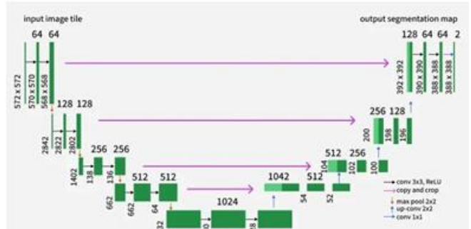
Fig. 7. Diagrama de una arquitectura U-Net con un input de 572x572 reducido a una dimensión de 28x28. Y posteriormente reconstruido a una resolución de 388x388.
