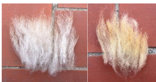
Figura 43. Fibres de xisqueta (esquerra) i ripollesa (dreta) pentinades. Elaboració pròpia.
