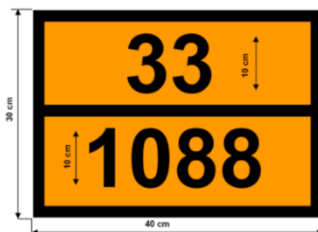
Figura 5.10: Panel naranja numerado correspondiente a ACETAL (1088) y peligro 33
