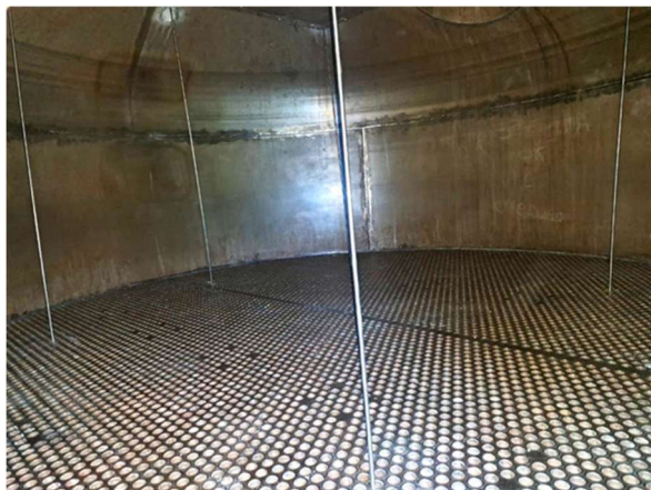
Figura 2.4. Mostra l'interior d'un reactor multitubular de carcassa i tubs.
