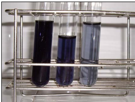
Imatge 4.1. Eliminació del color per a una solució de 146,543 ppm de colorant Gris Lanaset G i 4 g/l de carbó actiu.
