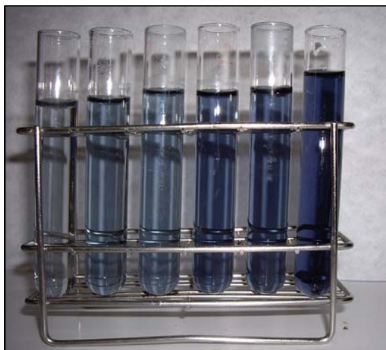
Imatge 4.3. Eliminació del color per a una solució de 153,537 ppm de colorant Gris Lanaset G i amb 11 g de carbó actiu.
