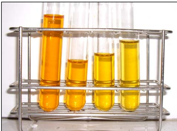
Imatge 4.2. Eliminació del color per a una solució de 166,400 ppm de colorant Orange G i 2,004 g/l de carbó actiu.
