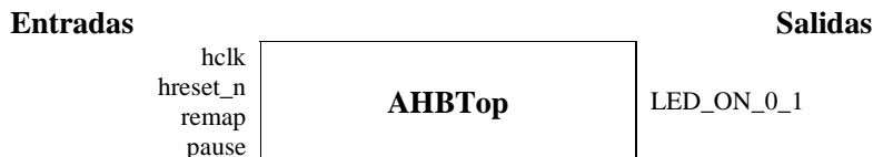
Figura 7. Esquema de las entradas y salidas del módulo AHBTOP
