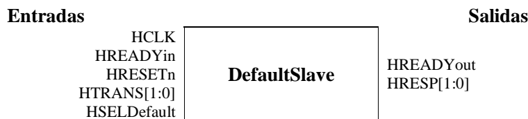
Figura 13. Esquema de las entradas y salidas del módulo DefaultSlave
