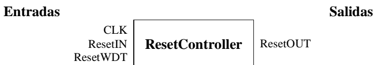
Figura 5. Esquema de las entradas y salidas del módulo ResetController
