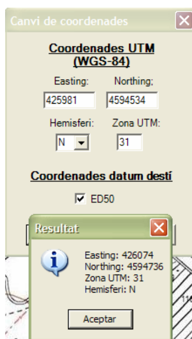
Figura 3.12. Eina de transformació de coordenades.
