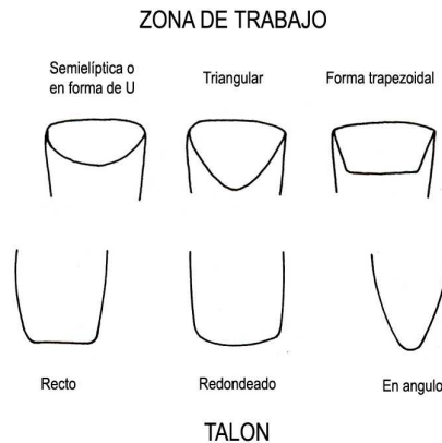
Figura 4. Sistema de clasificación de las áreas activas y las bases de los cinceles y otros instrumentos de uso similar, propuesto por Constanza Vega (1975: Lámina 6 modificada).
