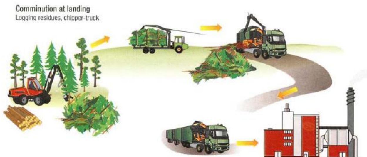
Figura 9.1. Sistema de treball vora pista, amb els processos d'extracció, trituració i transport a planta energètica. font: VTT Processes
