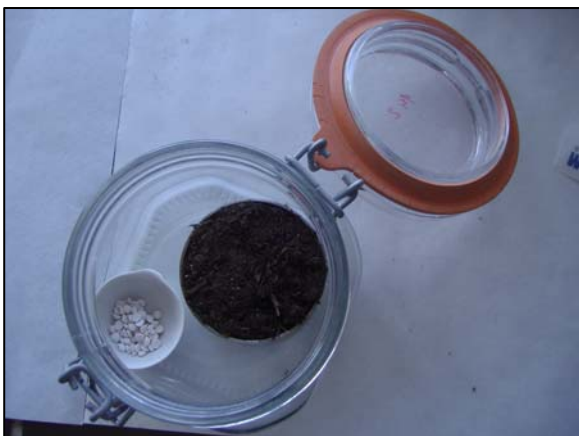
Detall del muntatge dels pots amb el la mostra de sòl en el cilindre i la soda-lime en un crisol.
