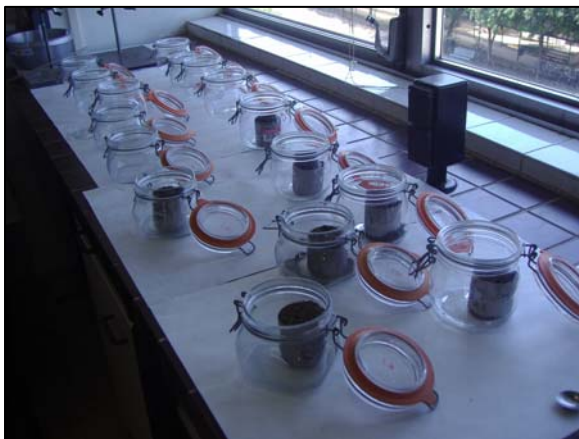
Preparació dels pots per la respirometria al laboratori
