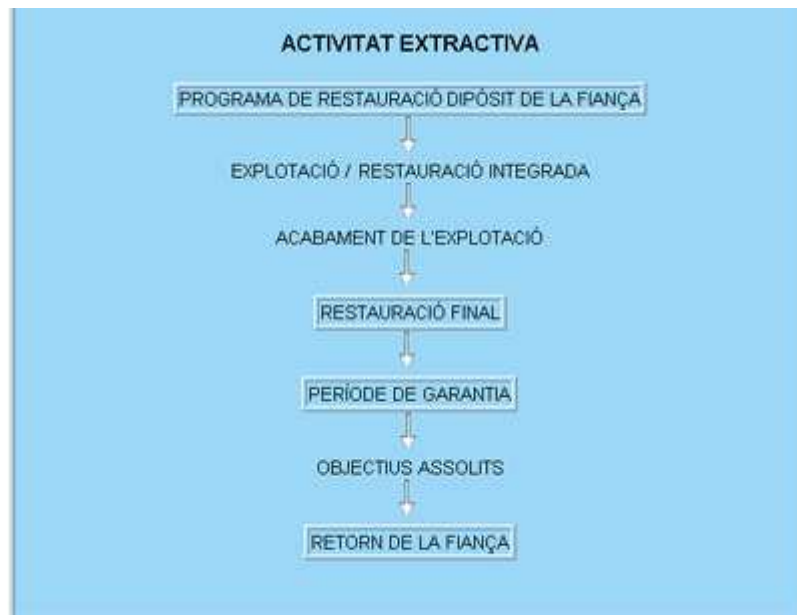
Figura 1. Esquema funcional de les etapes d'una activitat extractiva, d'acord amb la Llei 12/1981.
