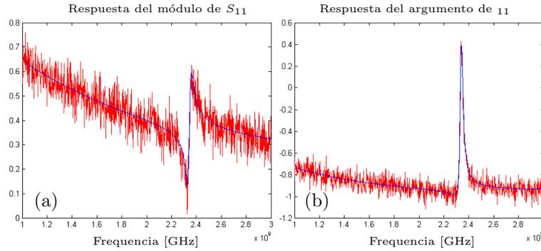
Figura 4.7: Resultado de la optimización con ruido gaussiano blanco: (a) Módulo de la medida de  $S_{11}$  (rojo) y optimización (azul). (b) Argumento de la medida de  $S_{11}$  (rojo) y optimización (azul).
