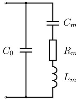
Figura 2.9: *Circuito equivalente del modelo de Butterworth Van-Dyke.*
