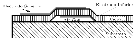
Figura 2.3: Resonador FBAR con reflexión de onda mediante Air Gap.
