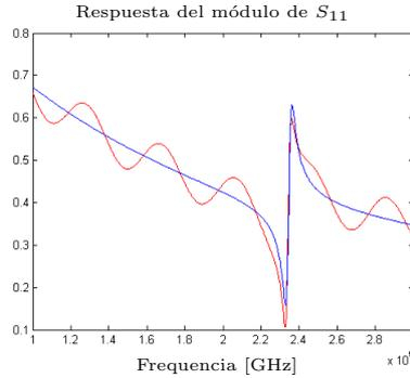
Figura 4.8: Resultado de la optimización con ruido senoidal: Módulo de la medida de  $S_{11}$  (rojo) y optimización (azul).
