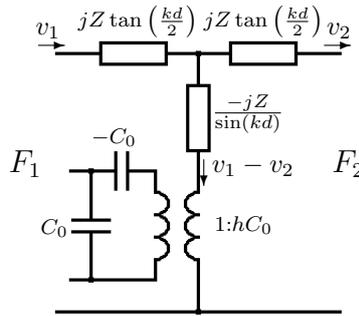
Figura 2.7: Modelo de impedancias acústicas para una lámina de material piezoeléctrico.
