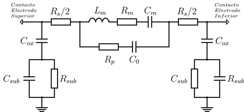
Figura 2.11: Circuito del modelo de Butterworth Van-Dyke Modificado.
