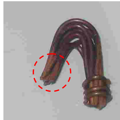
Fotografías 6.15 y 6.16 – Soldadura entre los hilos conductores como consecuencia de su fusión debido a la temperatura generada por el cortocircuito. Fotografías obtenidas con una cámara fotográfica digital.
