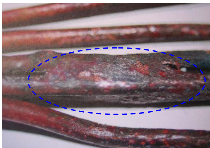
Fotografía 6.7 – Resaltada en azul se observa la soldadura producida entre dos hilos conductores de cobre por cortocircuito entre ambos.
