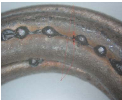
Fotografías 6.17 y 6.18 – Obtenidas mediante una lupa estereoscópica, muestran tanto la soldadura producida entre los hilos conductores, así como las perlitas (en forma de gotas oscuras) creadas por la fusión del cobre
