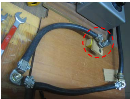
Fotografía 6.10 – Montaje experimental realizado para analizar las consecuencias de un defecto de presión entre los bornes de unión entre conductores (en rojo se marca la unión defectuosa por falta de presión)
