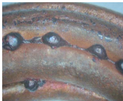
Fotografías 6.17 y 6.18 – Obtenidas mediante una lupa estereoscópica, muestran tanto la soldadura producida entre los hilos conductores, así como las perlitas (en forma de gotas oscuras) creadas por la fusión del cobre
