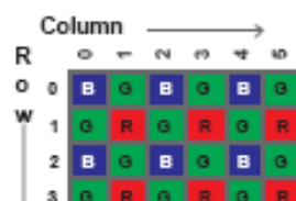
Figura 39. Vista de la distribució dels píxels en mode Bayer Pattern
