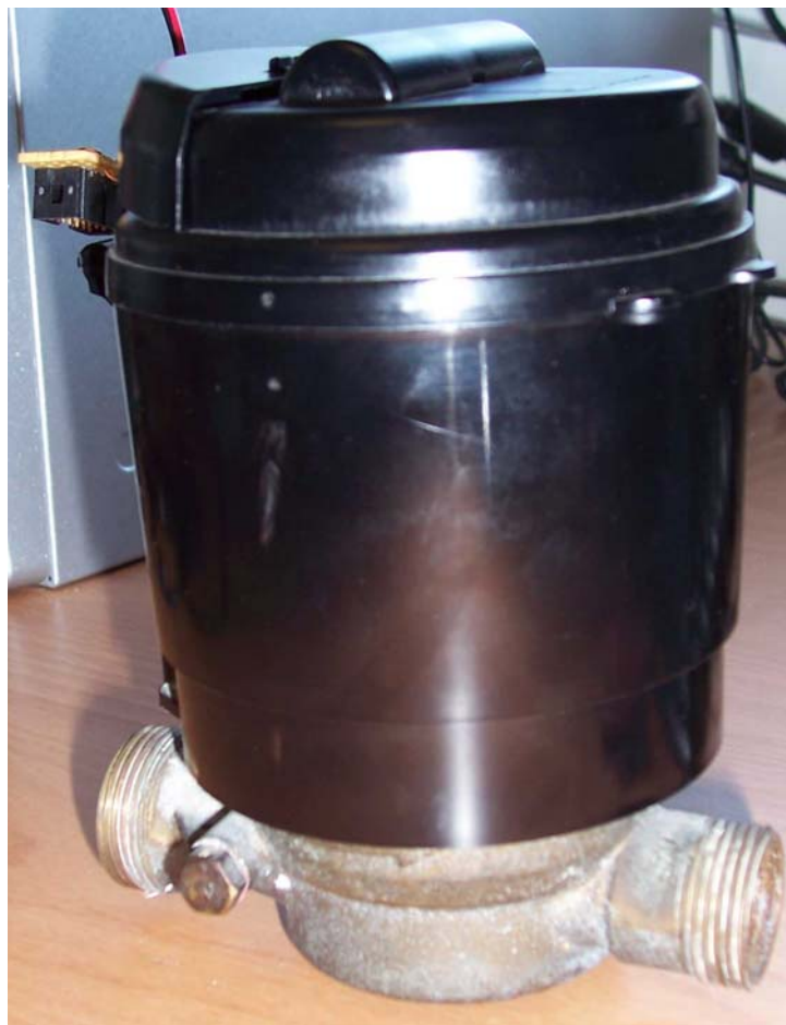
Figura 4. Imatge de la “txapela” del sistema Mirakonta muntat a un cabalímetre
