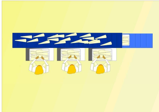
Figura 2: 2ª parte de la línea (envasado manual con control de cajas y peso)
