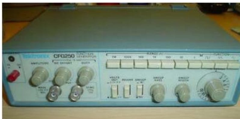
Figura 3.16. Fotografía del generador de ondas modelo Tektronix CFG250.
