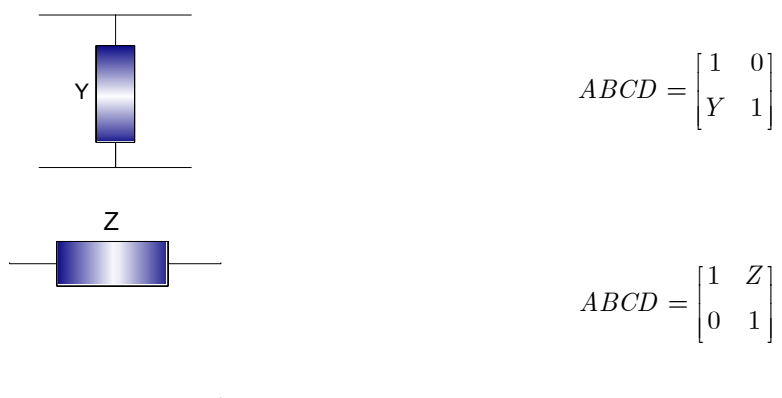
Figura A-1. Matrices de parámetros ABCD para una impedancia serie y una admitancia paralela.
