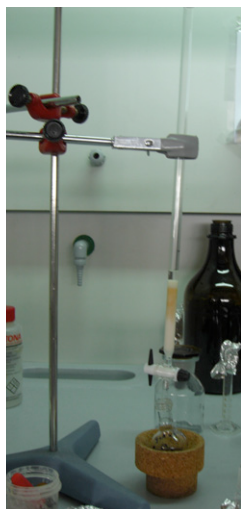
Figura 34. Cromatografia en columna amb l'elució de la FI.
