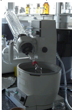
Figura 31. Imatge del rotavapor mentre s'evaporava un extracte.
