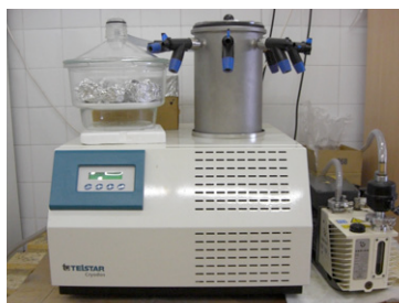
Figura 25. Imatge de la liofilitzadora en el moment de la liofilització de les mostres.
