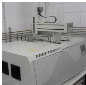
Figura 36. Imatge del GC-MS en el moment de l'injecció.
