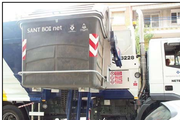
Figura 9. Camió realitzant la maniobra de buidatge d'un contenidor lateral de la fracció Resta (Coressa)
