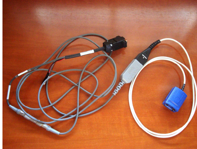
Figura 20. Sensor utilizado para la implementación del proyecto (Oxímetro Nonin)
