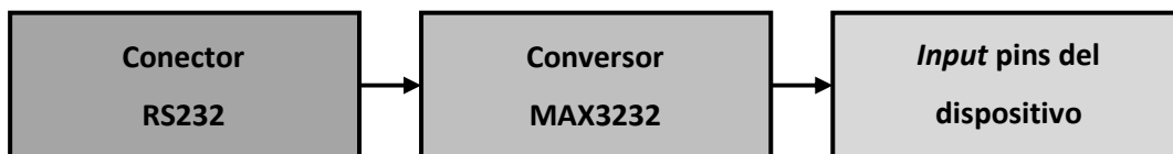
Figura 21. Bloques implementados en la placa adaptadora entre el sensor y el dispositivo
