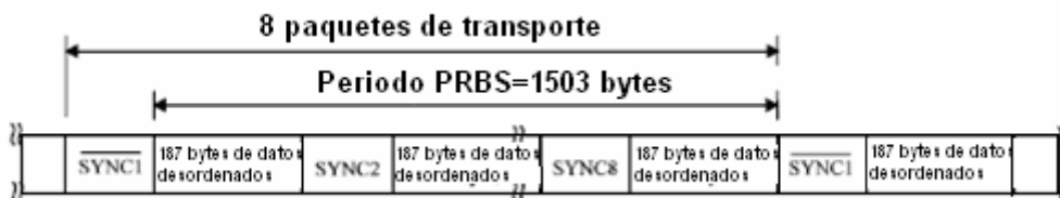
Fig. 4.5 Estructura del TS MPEG-2 resultado de la adaptación y dispersión de energía
