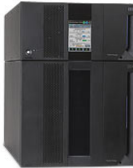
Figura 4-10: IBM TS3310 formado por el módulo básico, 3576 Model L5B, y una expansión.
