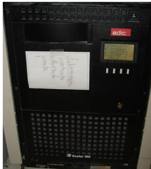
Figura 3-1: Librería ADIC Scalar 100 del departamento vista por delante. Se ve el display y el buzón de cintas: la pequeña puerta negra arriba a la izquierda.
