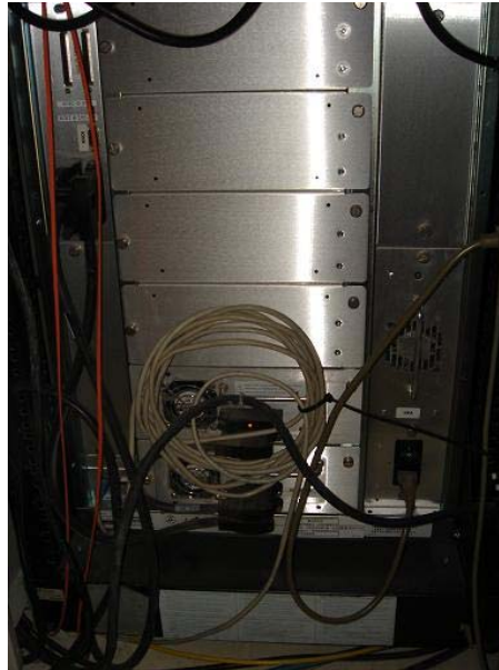
Figura 3-2: Librería ADIC Scalar 100 del departamento vista por detrás. Se pueden apreciar los 2 drives abajo conectados por SCSI, la salida SCSI que va al servidor arriba a la izquierda y la conexión Ethernet abajo a la izquierda.
