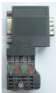
Figura 23: Conector SIEMENS con referencia 6es7 972-0bb50-0xa0
