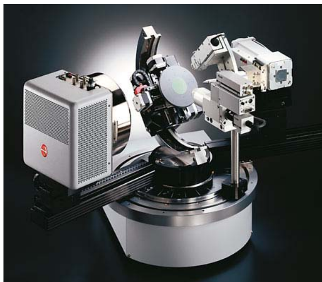
Figura 2.3.1. Aparato de difracción de Rayos X GADDS de la compañía Bruker
