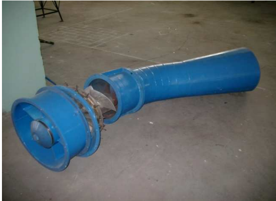
Imagen 6.10: Turbina hidráulica (axial tubular D300). Autor: Ernesto Fariñas Wong.
