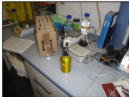
Imatge 3.3. Control baromètric dels reactors. Elaboració pròpia. Abril 2009.
