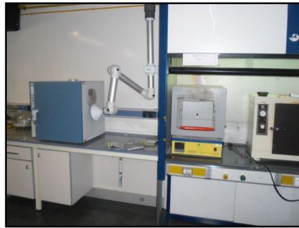
Imatge 3.2. Estufa i mufla emprades per a la caracterització del llot. Elaboració pròpia. Abril 2009.
