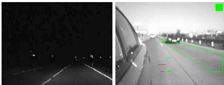
Figura 2.3: Izquierda: Sistema de control automático de luces largas. Derecha: Cobertura del ángulo muerto de espejos retrovisores.
