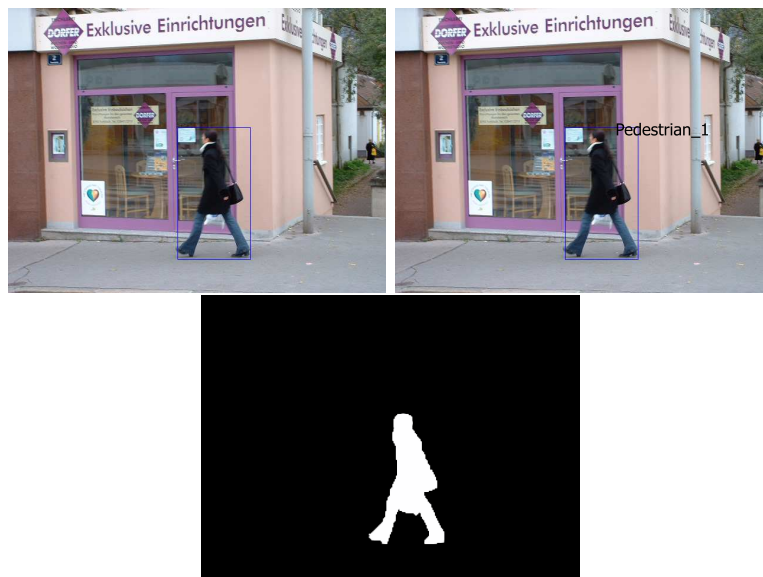
Figura 2.6: Tipos de groundtruth. Izquierda: Clasificación. Derecha: Seguimiento. Abajo: Segmentación.
