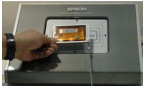
**Figura 7.1 Etiqueta RFID fabricada por EPSON [44], este tipo de etiqueta incorpora una pantalla de tecnología EPD que permitirá mostrar la información del producto cuando se pase por un escáner RFID**
