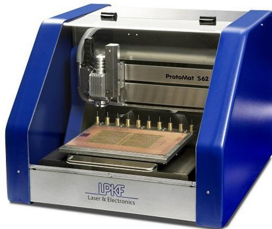
**Figura 6.1 Fresadora LPKF S62 [45]**
