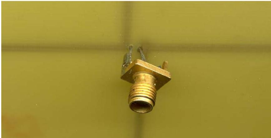
**Figura 6.6 Conector soldado en la parte trasera de la antena Quasi-Log**
