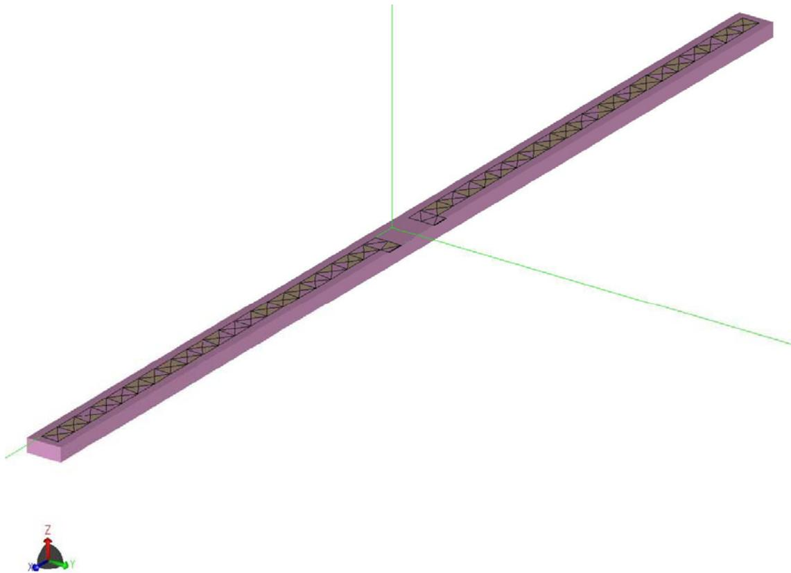
**Figura 4.11 Dipolo simple sobre sustrato FR4**
