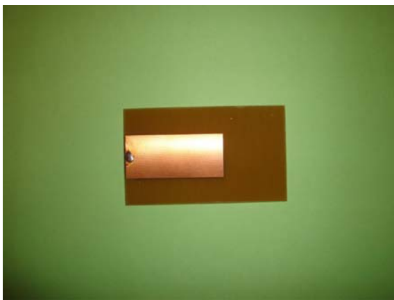
Figura 4-43 Línea para caracterizar el sustrato de FR4
