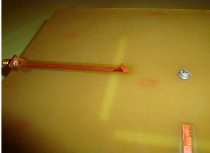
Figura 4-97 Alargamiento del stub de las líneas de alimentación
