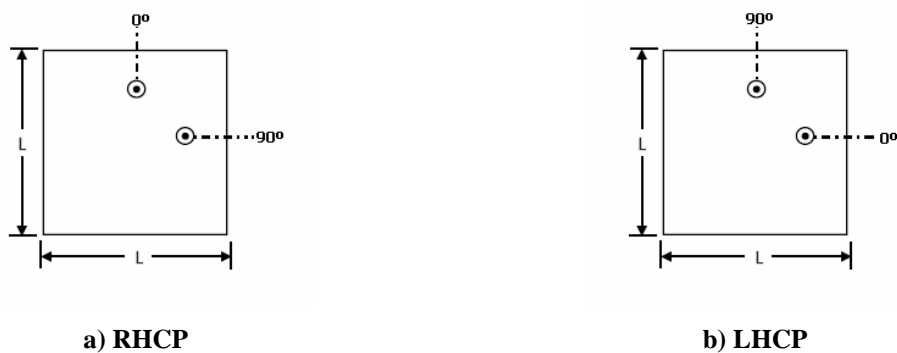
Figura 3-24 Configuraciones de desfase para conseguir polarización circular
