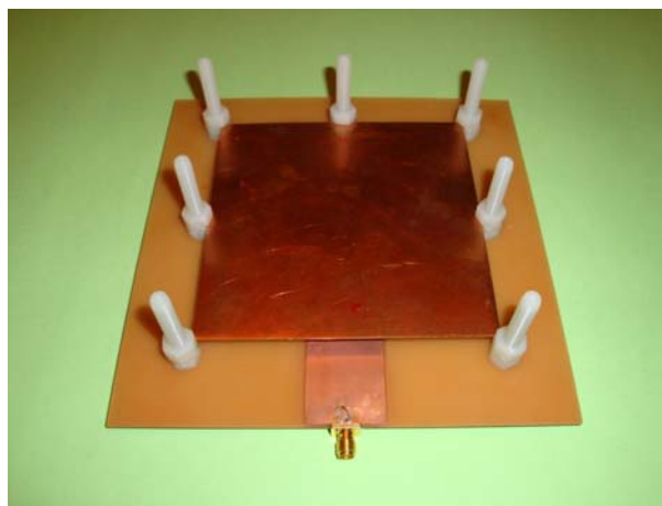
Figura 4-47 Nuevo diseño de antena con acoplamiento por proximidad fabricado
