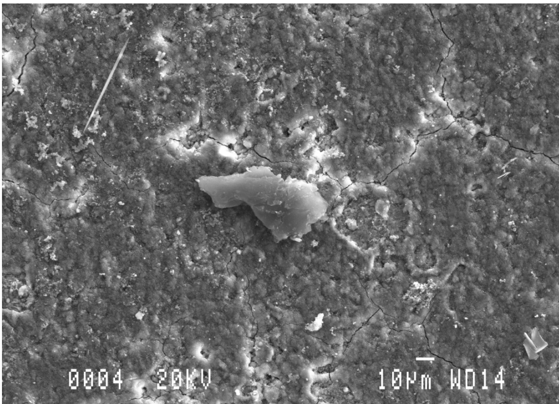
Imagen 5.3.3.- Supuesta partícula de calcita en la pasta de cemento de 28 días de edad sobre matriz amorfa.
