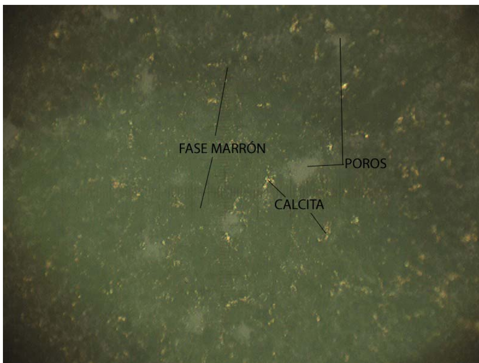
Imagen 5.1.1.2: Micrografía igual a la anterior pero con LPA.
