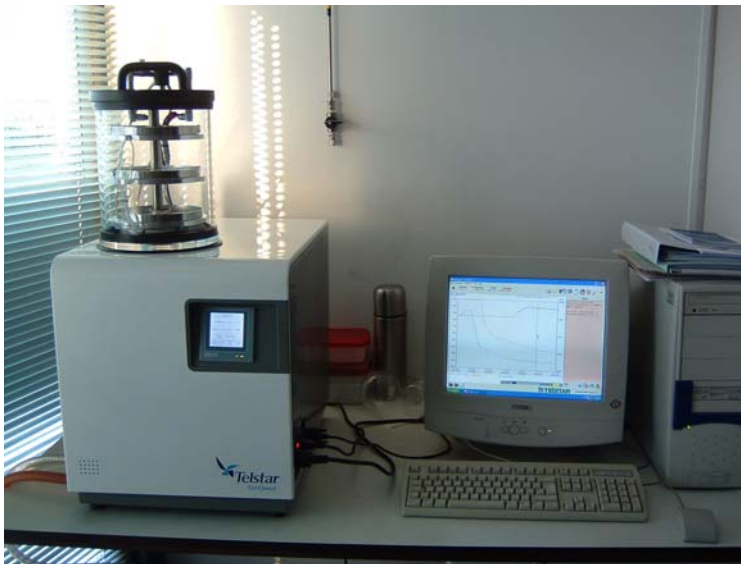
Fig. 1.- Fotografia de l'equip Lyoquest instal·lat a l'ICMAB
