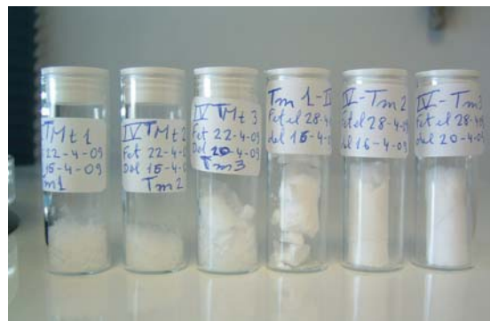
Fig. 16.- Liogels fets a partir de gels en tert-butanol amb diferent temps d'envelliment
