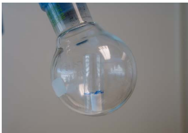
Fig. 4.- Liogel IV-A5 b rentat amb aigua liofilitzat amb manifold el 17-12-08
