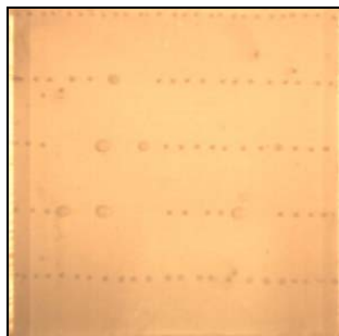
Fig. 4.7.1.3: Fotografía tomada con cámara digital después del tratamiento térmico. Distancia entre gotas 40 \mu m (250 Hz)
