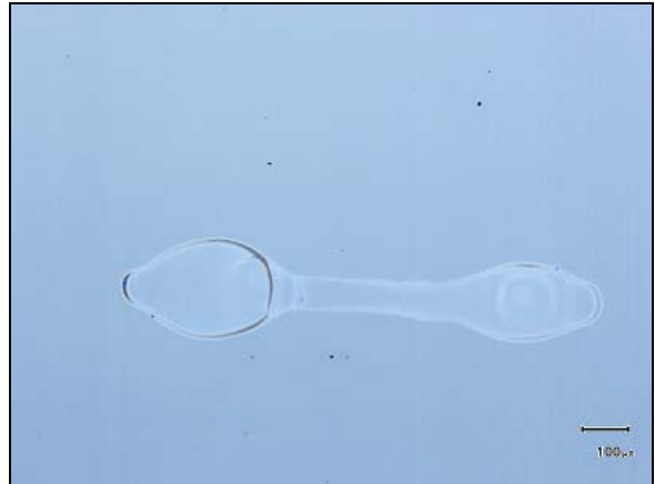
Fig. 4.7.1.2: Fotografía tomada con microscopía óptica. 50x. Muestra después del tratamiento térmico. Distancia entre gotas 25 \mu m (400 Hz)
