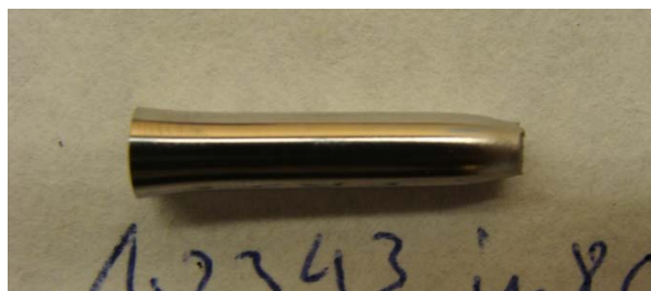
Figura 66. Aspecte de la proveta d'1.2343 assajada amb inhibidor a 80°C
