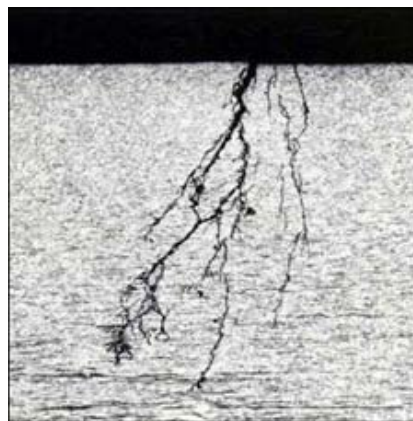
Figura 5. Exemple d'esquerda de SCC altament ramificada en un acer inoxidable.
