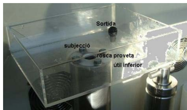
Figura 17. Cubeta de protecció muntada a l'útil inferior.
