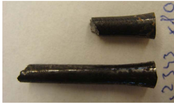
Figura 59. Aspecte de la proveta d'1.2343 assajada en aigua de xarxa a 80°C.
