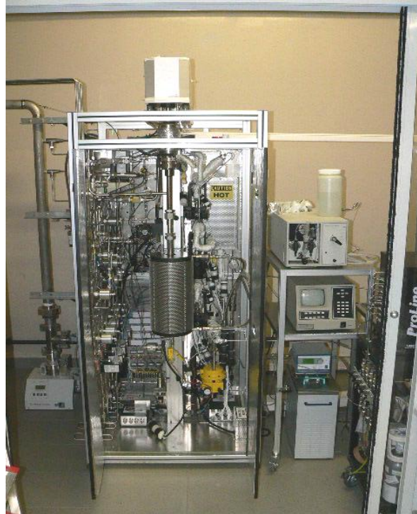
Figura 4.6 Microbalanza utilizada para el análisis de captura de CO 2 .
