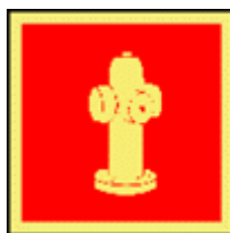
Figura 5.11.3.4.1.1. Señalización de un hidrante.
