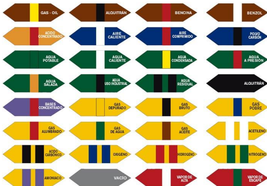
Figura 5.9.5.1. Detalle de los diferentes tipos de señalización de tuberías en función del compuesto químico transportado, siguiendo la norma DIN 2403.
