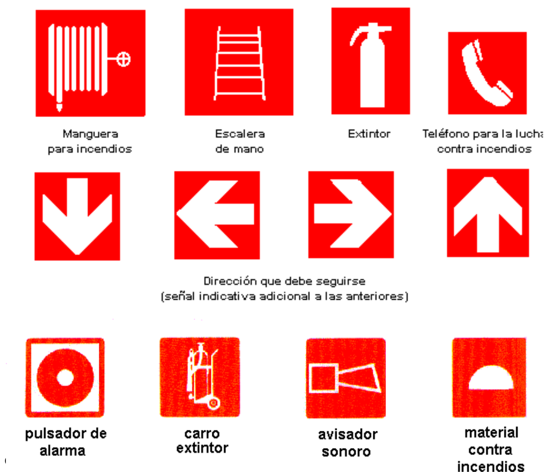
Figura 5.9.1.1.4.1. Señales relacionadas con la extinción de incendios.
