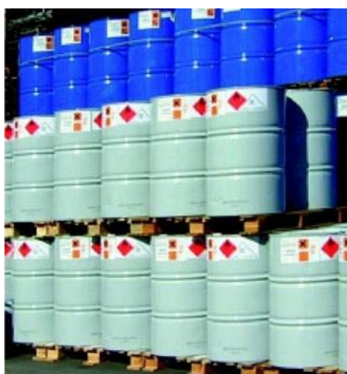
Figura 5.9.5.1. Recipientes etiquetados según normativa de comercialización y transporte de sustancias o preparados peligrosos.
