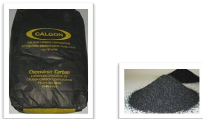
Figuras 11.5.4.1. A la izquierda el tipo de suministro del carbón activo y a la derecha el carbón activo impregnado.
