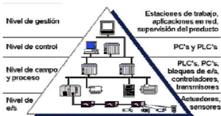
Figura 3-13. Estructura jerárquica de las redes industriales en una planta
