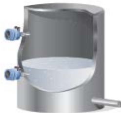
Figura 3-17. Instalación de un sistema de alarmas de nivel máximo y mínimo
