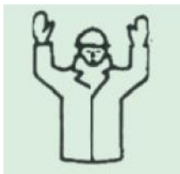
Figura 5.7. 7. Señales gestuales: Movimientos de peligro.
