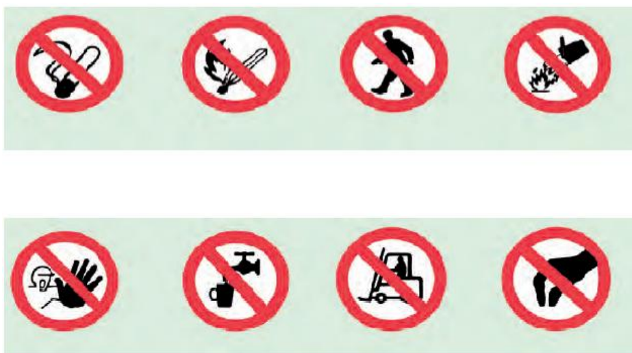
Figura 5.7. 2. Señales de prohibición
