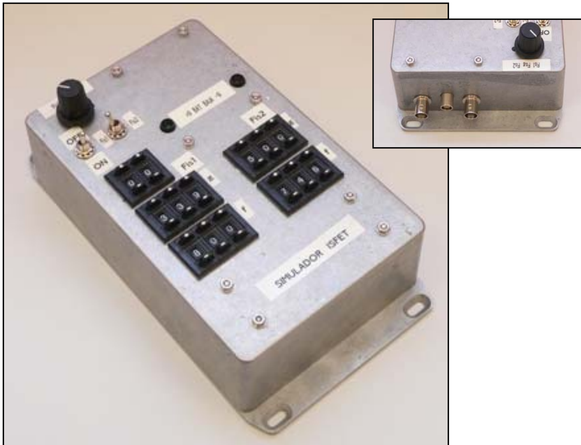
Figura 63: Panel frontal y conectores del simulador de ISFET
