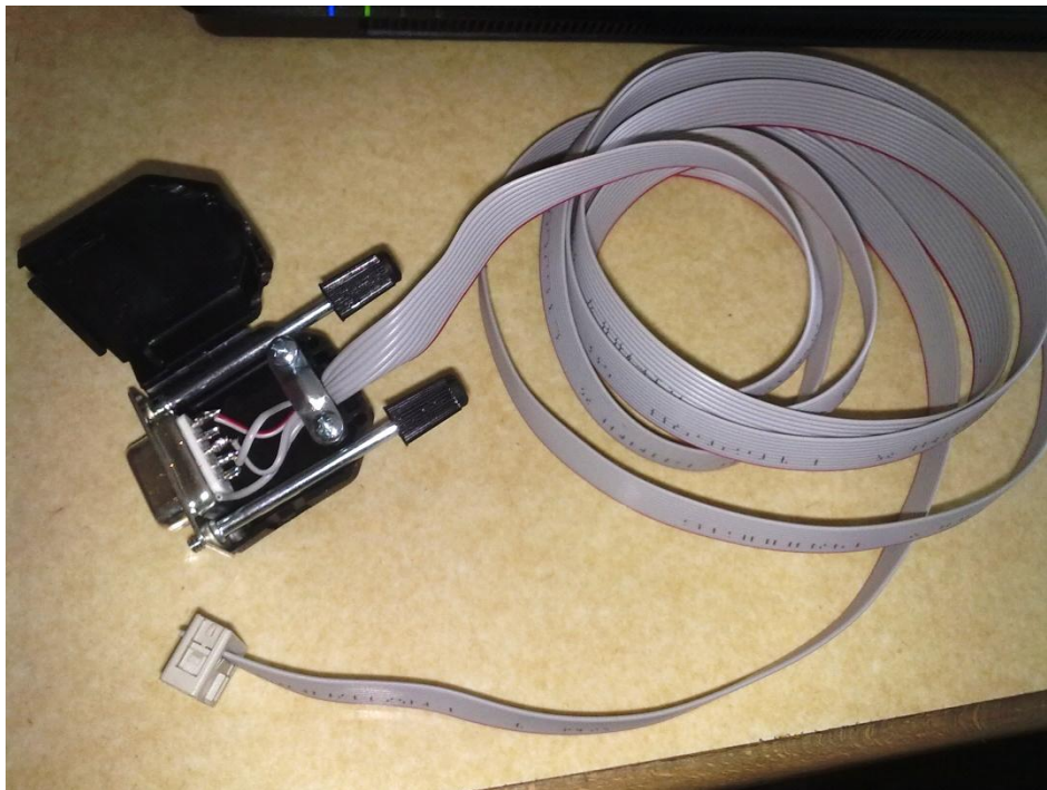
Figura 15. Cable para conectar el MAX232 con el PC mediante RS-232.
